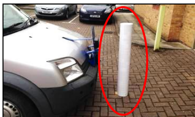
Paletto di 1 m davanti a una telecamera montata a 0,6 m di altezza
